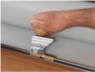
Anheben der Führungsschiene
